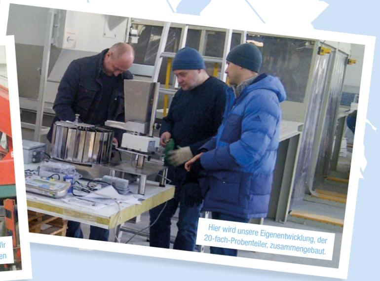
Hier wird unsere Eigenentwicklung, der 20-fach-Probenteiler, zusammengebaut.
