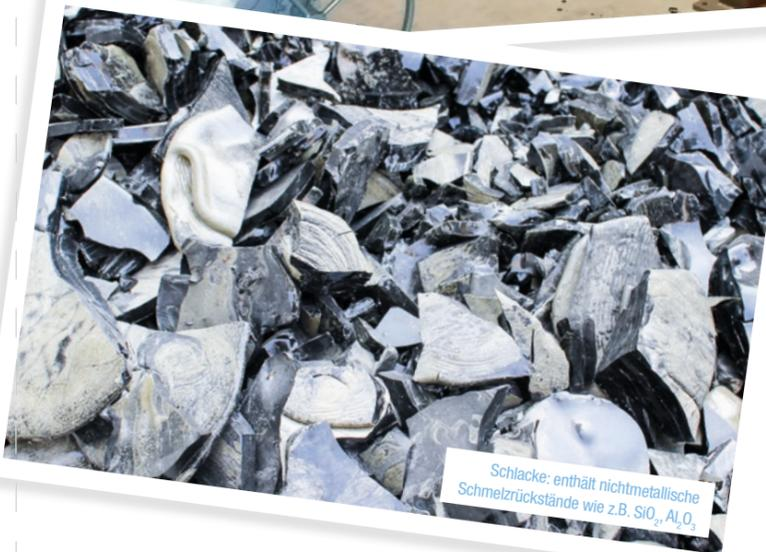
Schlacke: enthält nichtmetallische Schmelzrückstände wie z.B. SiO<sub>2</sub>, Al<sub>2</sub>O<sub>3</sub>
