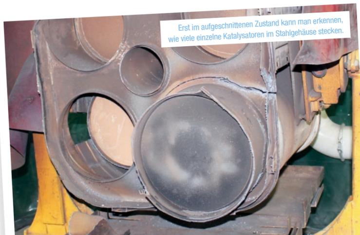
Erst im aufgeschnittenen Zustand kann man erkennen, wie viele einzelne Katalysatoren im Stahlgehäuse stecken.
